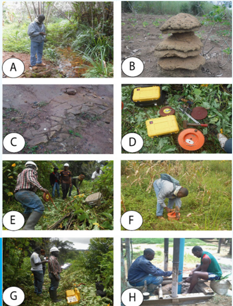
Figure 2 : Quelques étapes des prospections hydrogéologique, géologique et géophysique. (A) = identification d'un linéament drainé sur le terrain ; (B) et (C) identification de quelques indices hydrogéologiques (une termitière et une roche présentant de multiples fractures) ; (D), (E), (F) et (G) réalisation des SEV sur le terrain ; (H) contrôle de la mise en place des crépines lors de l'équipement d'un forage.
